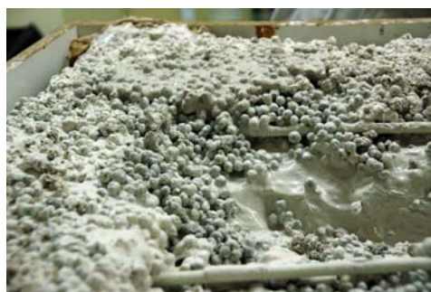
LÁMINA 14. MORTERO LIGERO CONFECCIONADO A BASE DE CERÁMICA EXPANDIDA Y YESO, COMO REFUERZO VARILLAS DE FIBRA DE VIDRIO DE 10MM. (FOTO: J. GARCÍA SANDOVAL)
